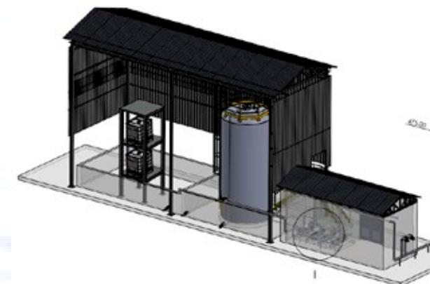
Projeto de dique de contenção, estrutura para IBC's Tanques em fibra de vidro, casa de bombas e tubulação
