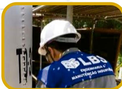
Inspeções por END's LP, EVS para manutenção em vasos de pressão
