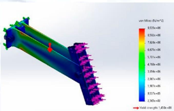
Simulação de solução para dispositivo de fixação de ACM do centro de convenções
