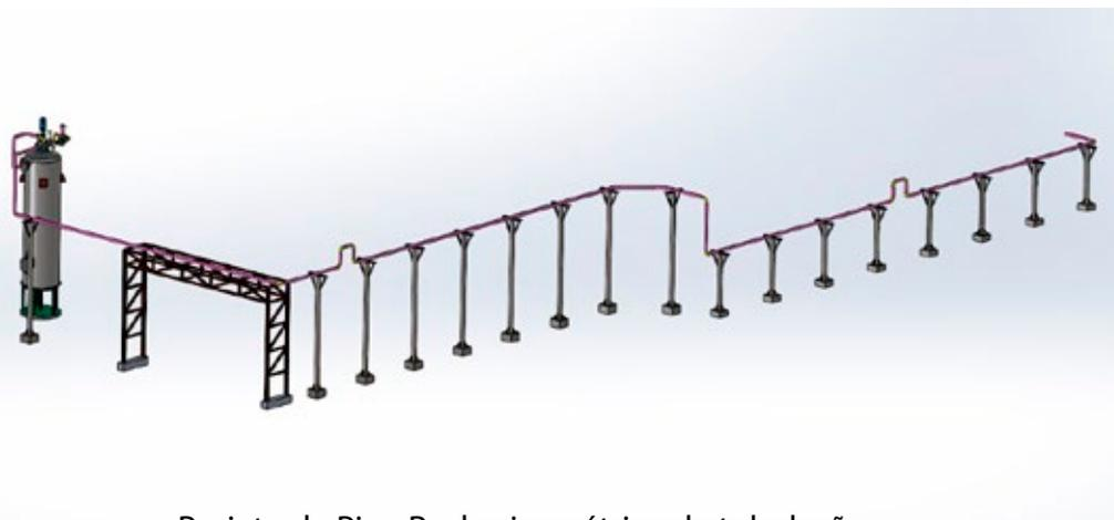
Projeto de Pipe Rack e isométrico de tubulação
