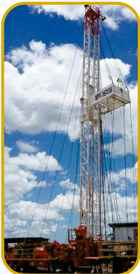
Inspeções por END LP/PM e EVS no mastro telescópico, cavalete, catarina bloco de coroamento, etc.
