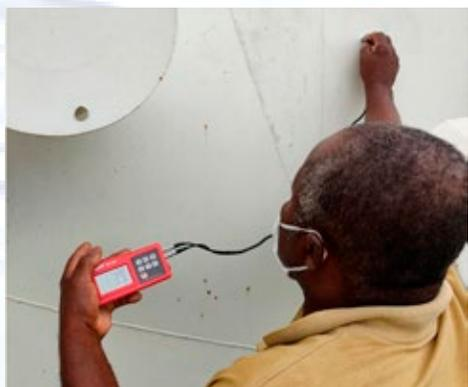
Medição de espessura de costado através de ultrassom
